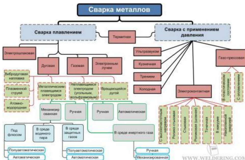
Принципы основных способов электродуговой сварки плавлением
