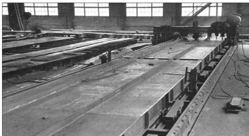
Рисунок 3 Процесс сборки ферм в кондукторе
